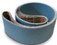
Abrasivo de alúmina de zirconio con capa abierta y efecto autoafilante, diseñado para trabajar con piezas de superficie dura y que ofrece un corte agresivo y una alta tasa de arranque de material. El ZK713X es particularmente adecuado para desbaste de chapas metálicas.
